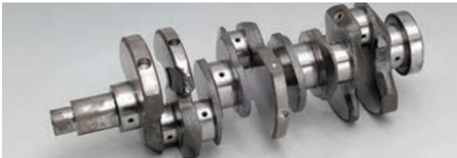
شکل ۱۶- میل لنگ آهن‌گری شده-محصول نهایی
