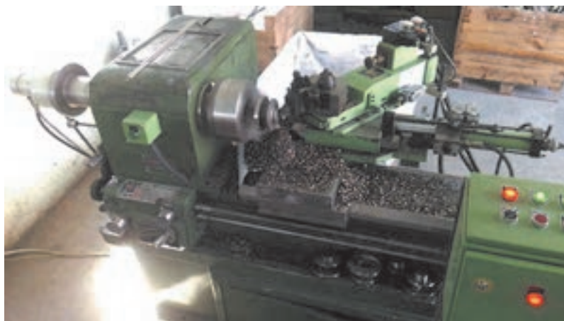
شکل ۷- عملیات کپی تراشی
