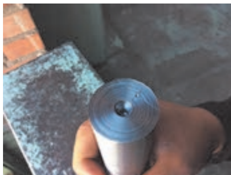
شکل ۲۲ - سنبه‌نشان‌زدن پیشانی قطعه کار
