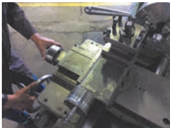
شکل ۱۰- حرکت همزمان سوپرت‌های دستگاه
