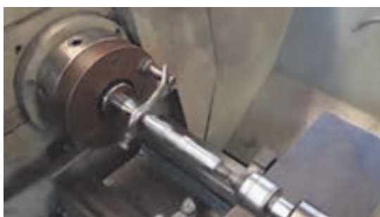
شکل ۲۰ - لنگ تراشی بین دو مرغک
