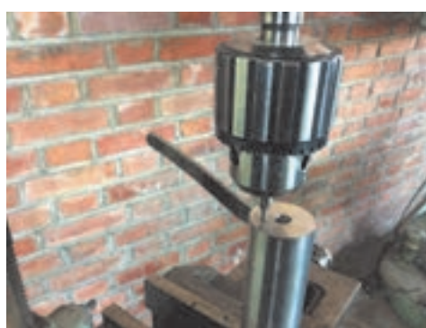
شکل ۲۳ - مته‌مرغک‌زنی به وسیله ماشین مته ستونی
