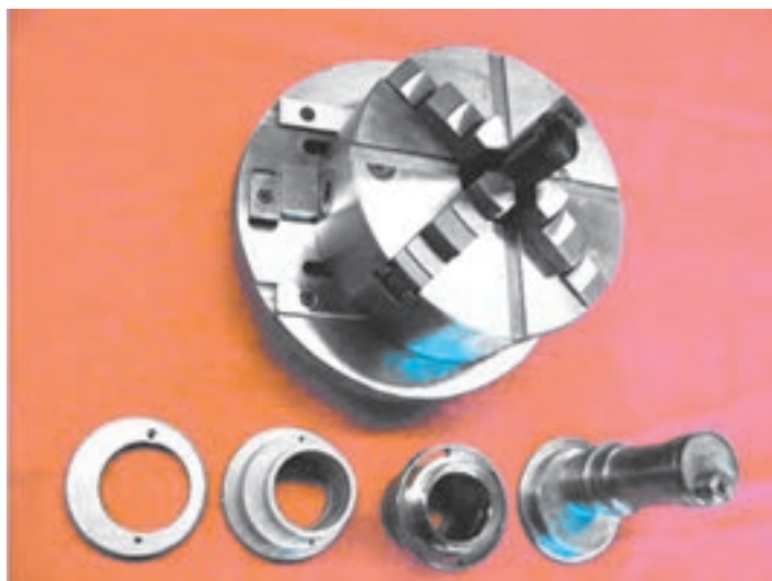
شکل ۱۷- سه‌نظام قابل تنظیم و قطعات تولید شده
