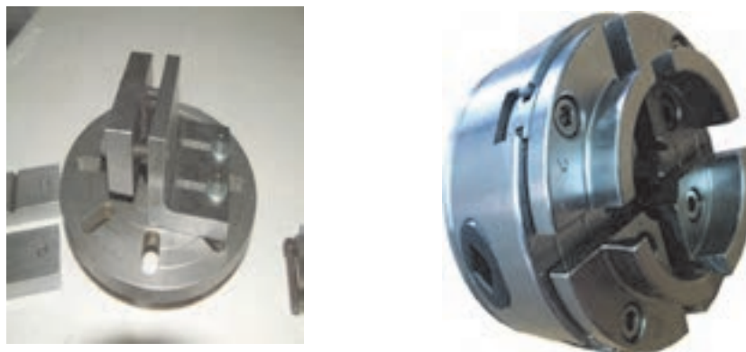
شکل ۱۹ - فیکسچرهای مخصوص لنگ تراشی
