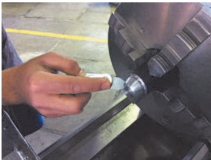
شکل ۱۲- کنترل فرم به وسیله شابلون
