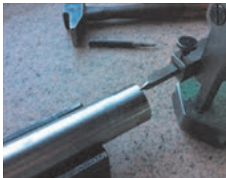
شکل ۲۱ - خط‌کشی و تعیین مراکز لنگ
