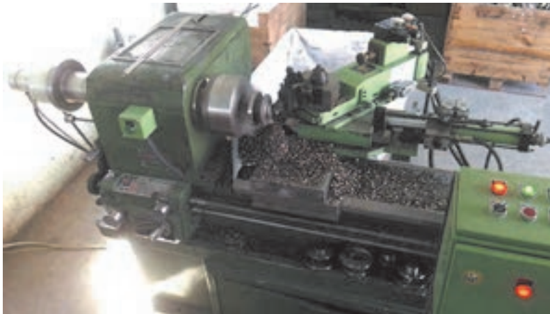
شکل ۷- عملیات کپی تراشی
