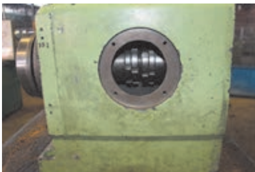
شکل ۴- سفت کردن یاتاقان جلوی دستگاه
