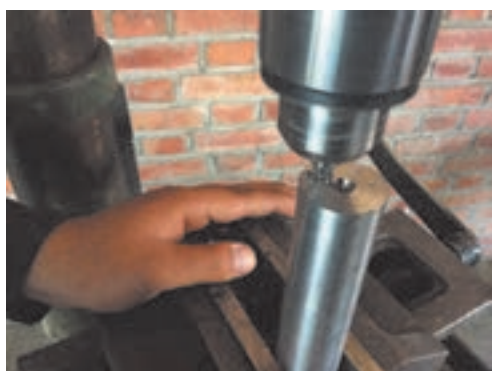
شکل ۲۳ - مته مرغک زنی به وسیله ماشین مته ستونی
