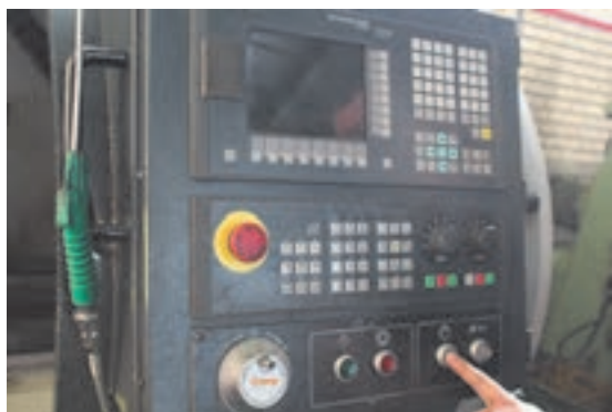
شکل ۱۹- روشن کردن سیستم هیدرولیک دستگاه
