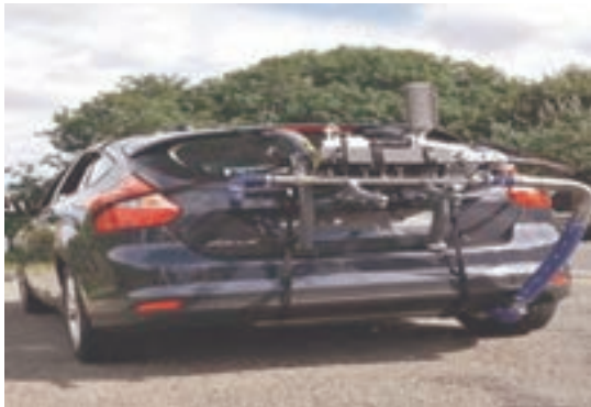
شکل ۱۱- تست آلاینده‌گی و بازرسی جاده‌ای برای تأیید اولیه خودرو
