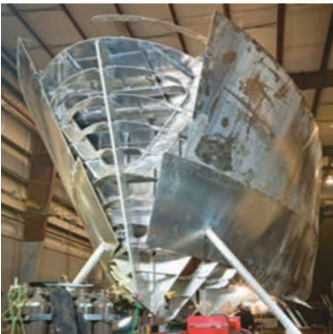
شکل ۲۳- سازهٔ سینهٔ یک شناور در حال ساخت
