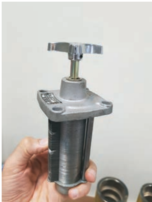
الف) نمای شماتیک و تصویری از بخش میانی فیلتر
