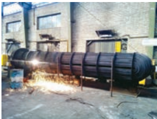
شکل ۱ - مبدل حرارتی ساخته‌شده برای نصب در پالایشگاه کرمانشاه را نشان می‌دهد.
