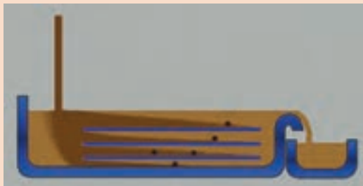
شکل ۲۰- نحوه قرار دادن صفحات موازی درون فیلتر
