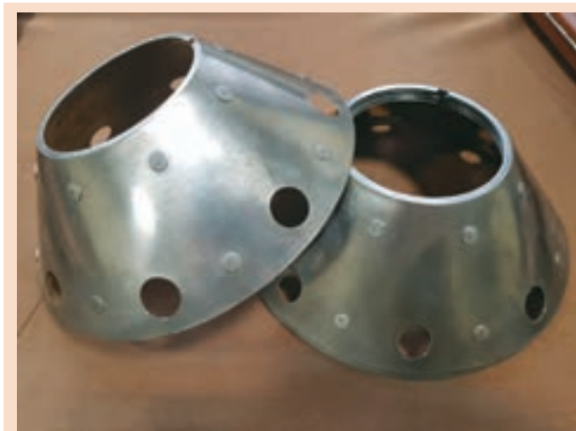
شکل ۲۳ - صفحات و کاسه‌های نازک درون فیلترهای با نیروهای گریز از مرکز
