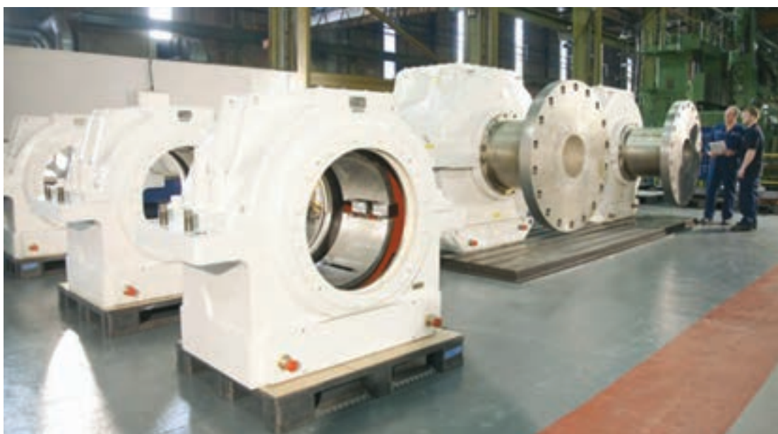
شکل ۲۴- یاتاقان‌های مورد استفاده جهت تکیه‌گاه محور پروانه
