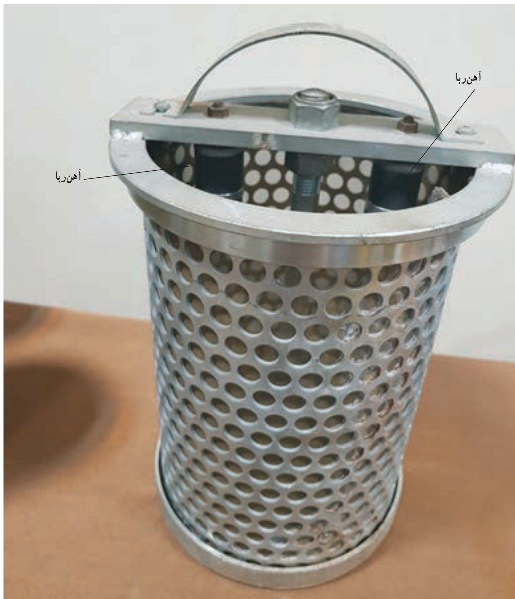
شکل ۱۵ - فیلتر مجهز به آهن ربا برای به دام انداختن ذرات فلز با پایه آهن
