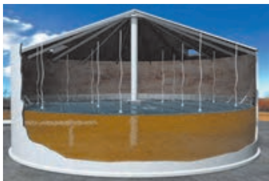
شکل ۱۸-۴ مخازن سقف شناور درونی
