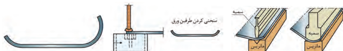
۱ انتخاب قالب و سمبه مناسب
