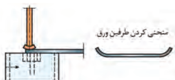
۲ منحنی کاری دو سر ورق
