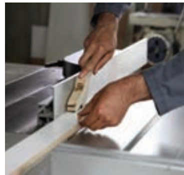
شکل ۵۱ - شیارزدن
