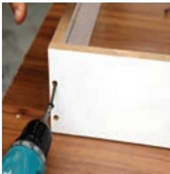
شکل ۵۳ - سوراخ کاری
