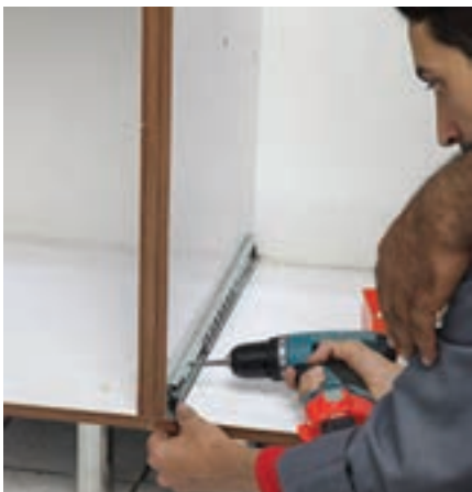
شکل ۸۲ - نصب قطعه یک تکه روی بدنه‌ها
