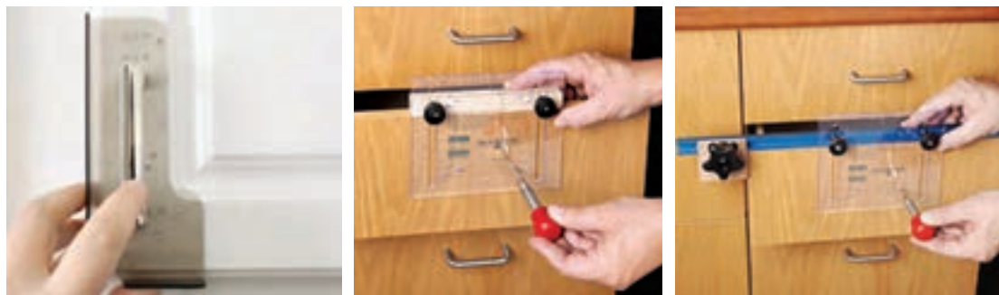
شکل ۱۳۵- چند نوع شابلون سوراخ کاری محل دستگیره
