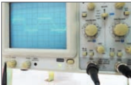
شکل ۶۱- موج سینوسی و مربعی روی صفحه نمایش
