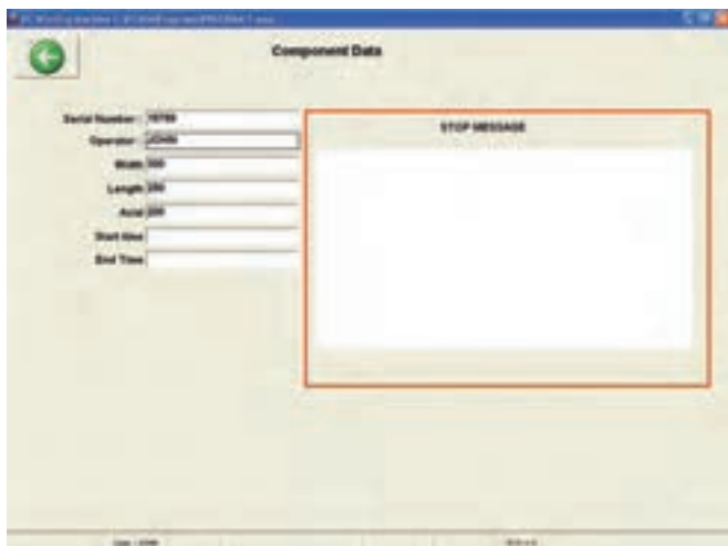
شکل ۳۱- نمونه‌ای از منوی دستگاه بوبین پیچ
