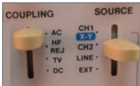
شکل ۶۹- وضعیت‌های کلید Source
