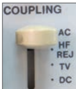
شکل ۷۴- وضعیت‌های کلید کوپلینگ
