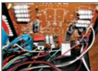
شکل ۱۳۲- برد الکترونیکی و کنترل شدت هوای فشرده
