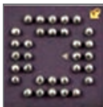
شکل ۲۱- تصویر ظاهری انواع پکیج‌های BGA
