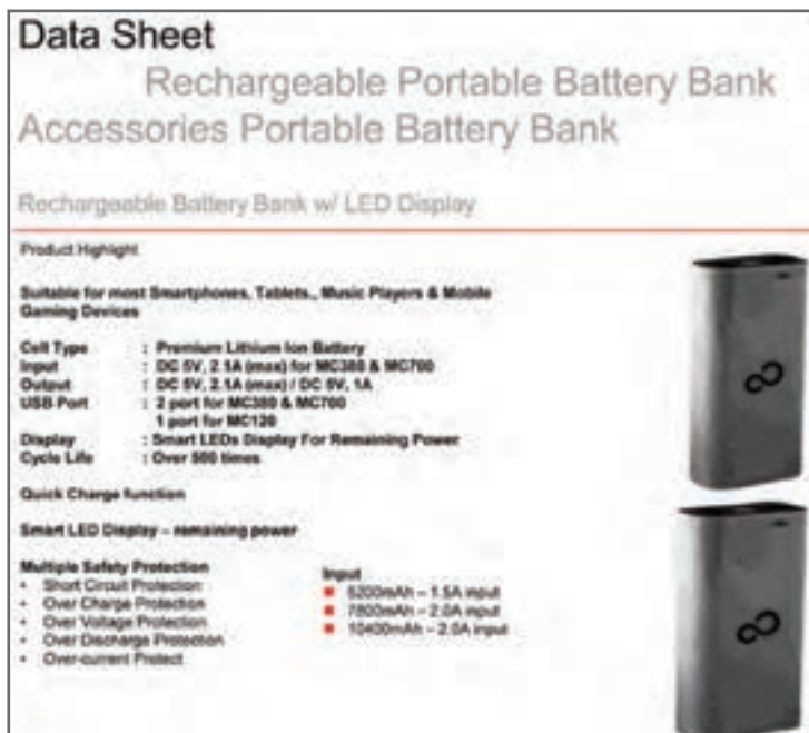
شکل ۲۱- برگه مشخصات یک نمونه پاور بانک
