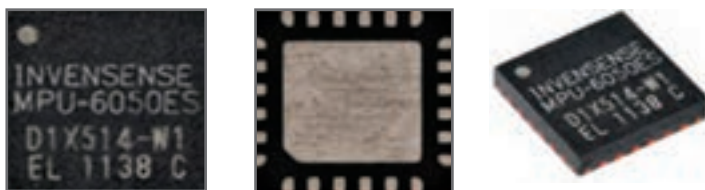
شکل ۲۰- تصویر ظاهری انواع پکیج‌های TDFN، DFN
