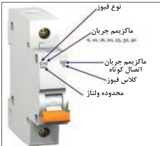
شکل ۱- مشخصات یک نوع فیوز مینیاتوری
