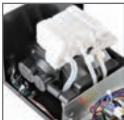
شکل ۱۲۸- مولد هوای فشرده (کمپرسور) باد
