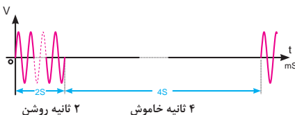
شکل ۸۴ - مشخصات سیگنال بازتاب زنگ
