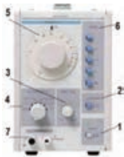
شکل ۳۸ - کلیدهای حوزه کار یا رنج فرکانس
