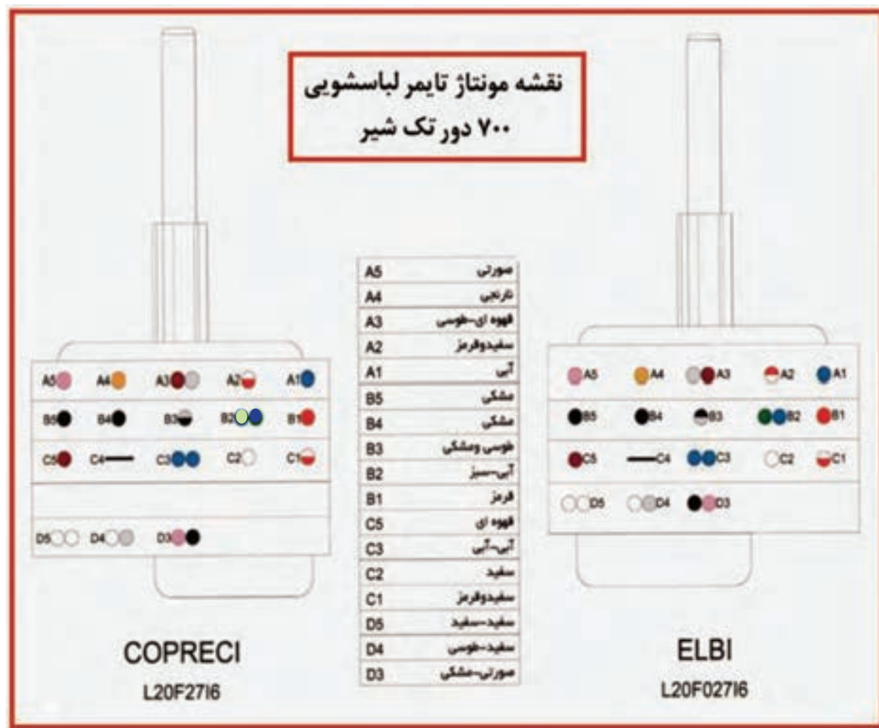
شکل ۱۶۵-۱ نقشه مونتاژ تایمر لباسشویی ۷۰۰ دور تک شیر
