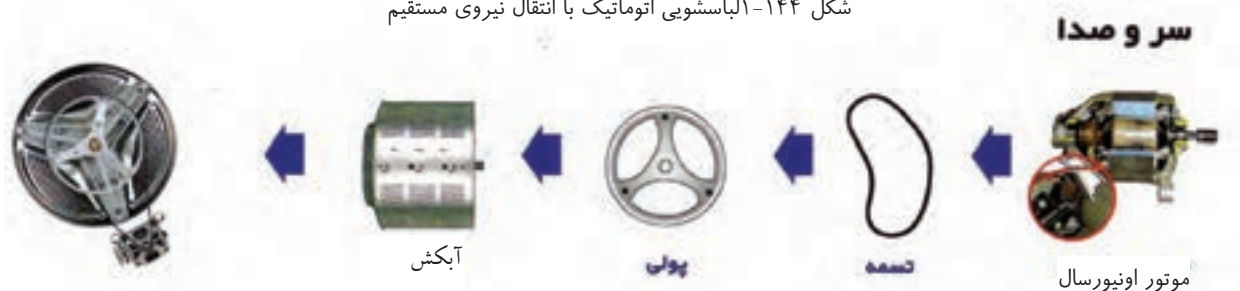
شکل ۱-۱۴۵-الباسشویی اتوماتیک با انتقال نیروی غیرمستقیم
