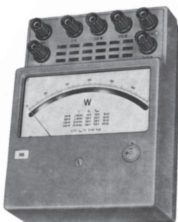
شکل ۵-۳۶—شكل ظاهری وات متر
