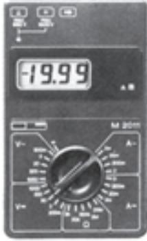
شکل ۴-۵- نمونه دستگاه دیجیتالی
