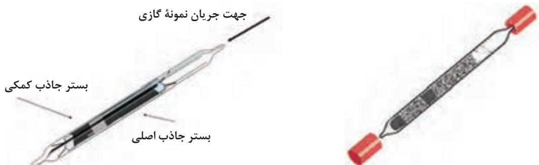
شکل ۲۰- لوله جذب سطحی حاوی زغال فعال
