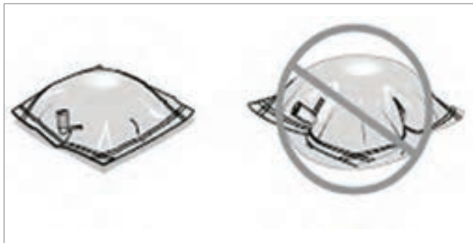
ب) روش صحیح و اشتباه پر کردن کیسه نمونه گیری
