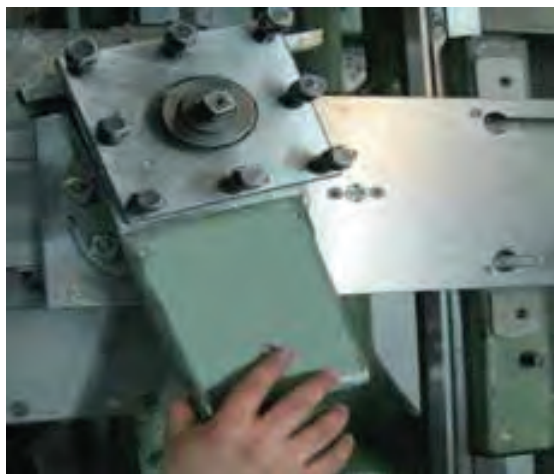
شکل ۱۲- مخروط تراشی به روش انحراف سوپرت بالایی
