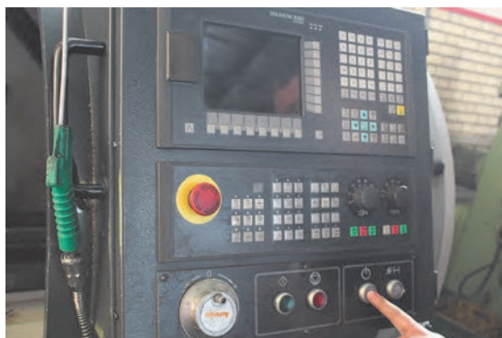
شکل ۱۹- روشن کردن سیستم هیدرولیک دستگاه
