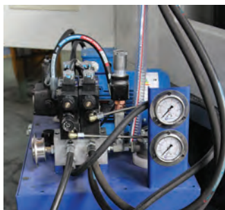
شکل ۱۱- سیستم هیدرولیک ماشین تراش CNC مدل ۴۰ TME
