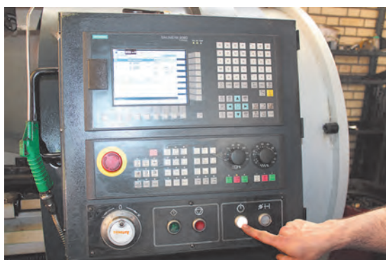
شکل ۲۱- زدن مجدد کلید سیستم هیدرولیک
