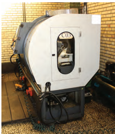
شکل ۱۲- سیستم هیدرولیک دستگاه و مرغک
