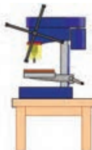
استفاده از چرخ دنده‌های شانه ای
