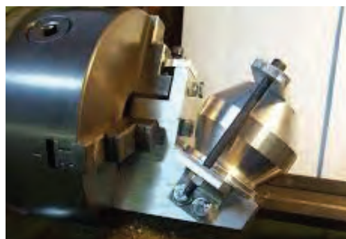
شکل ۳۵- فیکسچرهای تراش کاری
