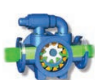
استفاده از چرخ دنده‌های داخلی
